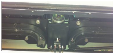
图5 塞拉门驱动电机
