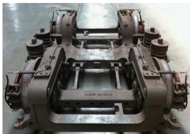
图3 拖车转向架
