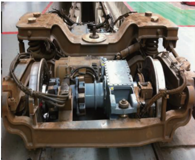
图2 动车转向架
