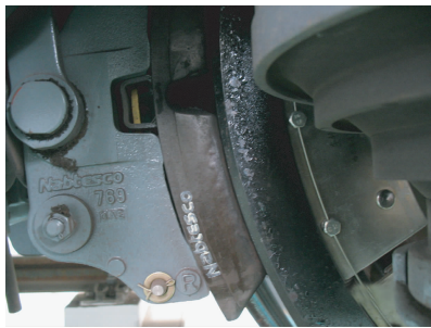
图1 轮辋漆碳化和闸瓦过热产生鼓疱变形
