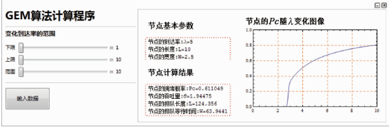
图 1 节点拥堵概率随到达率变化的曲线
