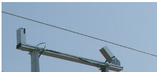
图4 基于面阵相机的接触网检测方式
