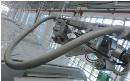
图7 电客车压力检测安装
