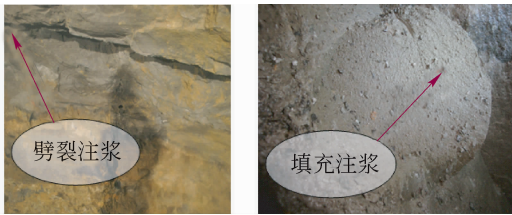
图 12 超前帷幕注浆劈裂、填充扩散情况
