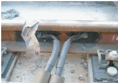
图1 回流焊接点断裂
