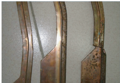
图1 出现裂纹或断裂的导流板
