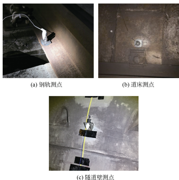
图 1 隧道内振动测点布置
